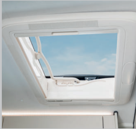
Neue große Dachluke im Frontbereich mit Verdunklungsrollo und Fliegengitter
